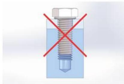
Für eine maximale Sicherungswirkung sollten die Original SCHNORR® Sicherungsscheiben **nicht** auf dem Kopf angewendet werden.
