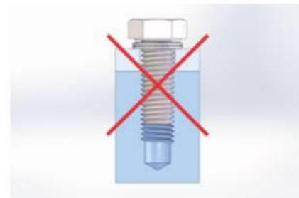
Für eine maximale Sicherungswirkung sollten die Original SCHNORR® Sicherungsscheiben **nicht** gestapelt werden.
