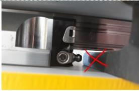
Bei der Montage der Schmiernippel ist die Zugänglichkeit mit dem Befüllwerkzeug sicherzustellen
